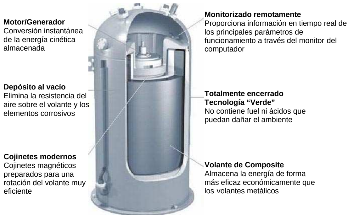
Figura 6.41. Volante de inercia
