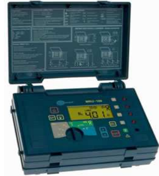
Figura 7.22b. Telurómetro para medir la resistencia de puesta a tierra y la resistividad por el método de Wenner
