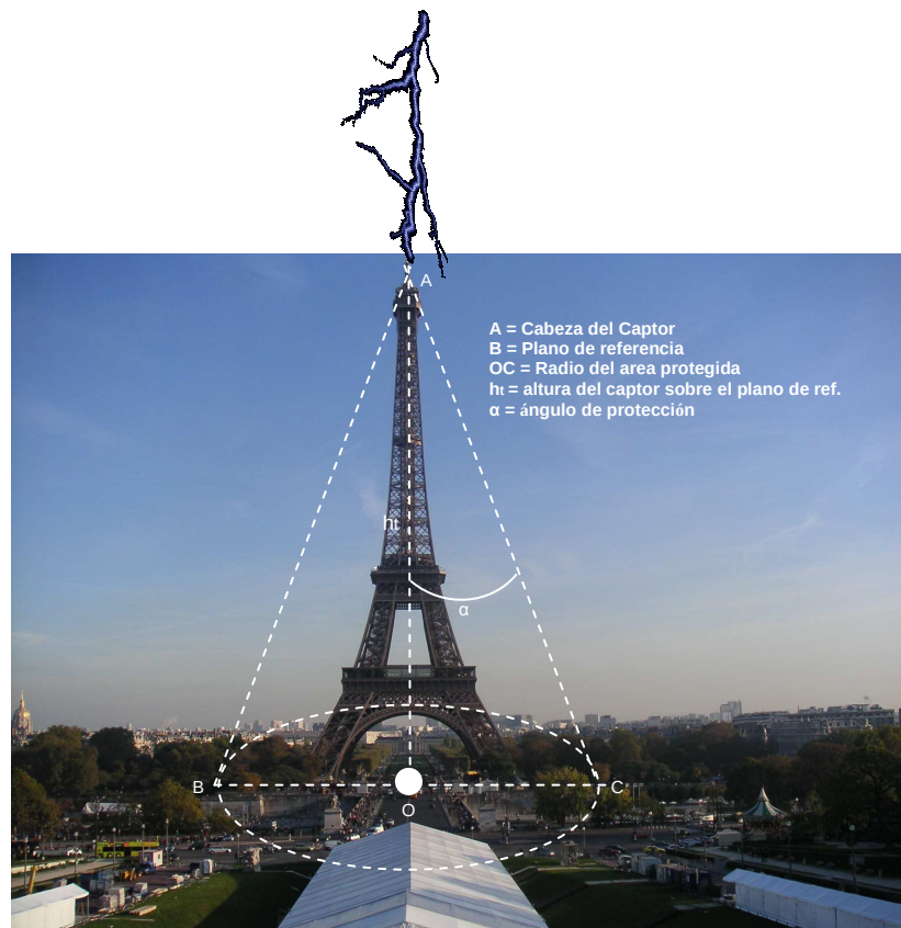
Figura 7.19. Cono de protección de un pararrayos instalado en una torre
