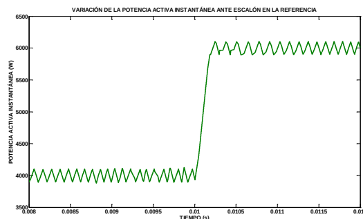
Fig. 33. Variación de la potencia activa instantánea ante escalón en el modelo combinado
